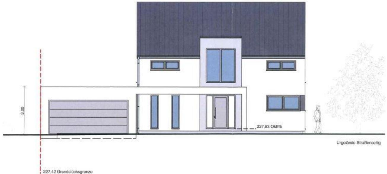
Abbildung 2: Beispiel für eine zweigeschossige Bebauung mit einer Traufhöhe von 5,00 m
