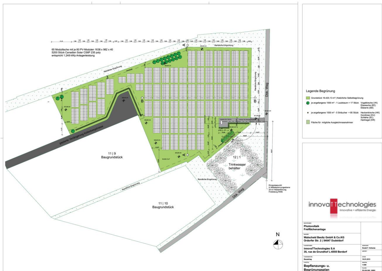
Abbildung 1: Darstellung der geplanten Photovoltaik Freiflächenanlage (Innovattechnologies 2012)
